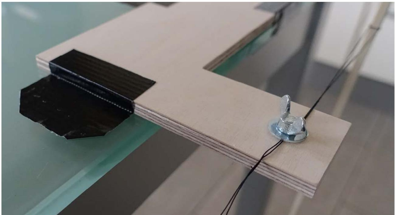
**Fig. 6**      **Fixation par ruban adhésif (à gauche) et vis à oreilles avec rondelle (à droite)**
