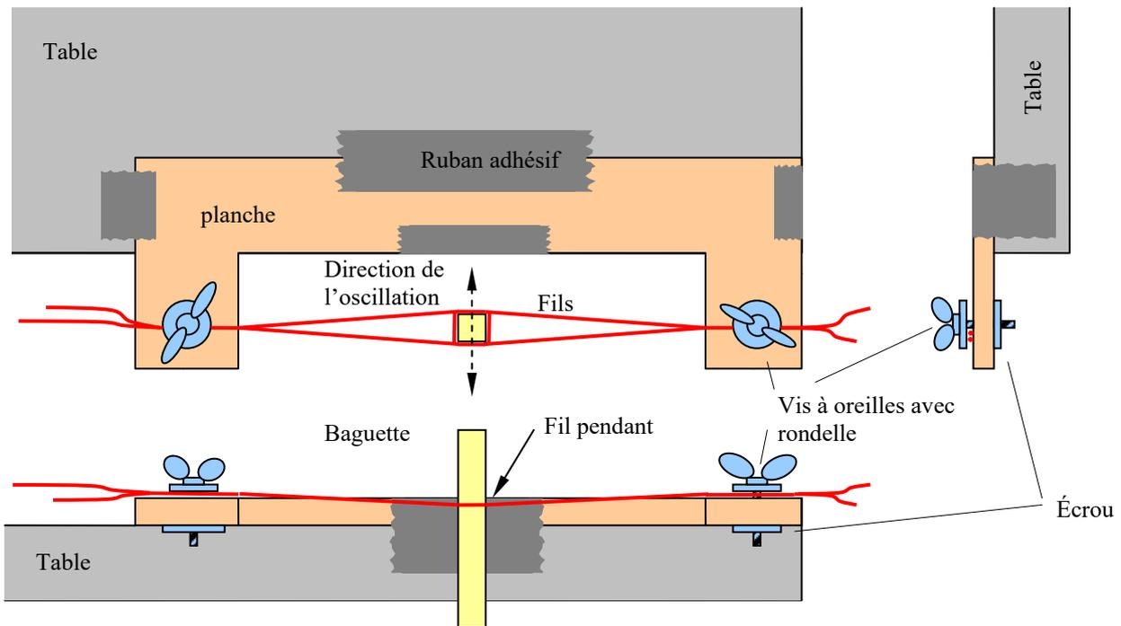
**Fig. 2** Vue du dessus (en haut) et vues de côté (en bas et à droite) de la planche
