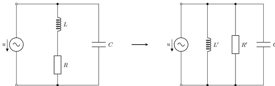
Figura 2: Sinistra: circuito iniziale. Destra: circuito trasformato.
