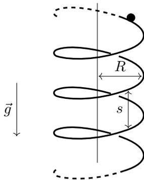
On étudie le mouvement d'une bille de masse  $m$  qui roule sur la piste. On repère la position de la bille sur l'hélice par sa distance  $l(t)$  le long de la piste depuis sa position initiale.
