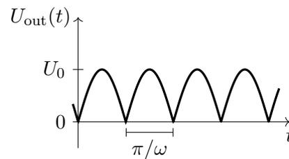
iii. (2.5 P.) **Qu'apporte le pont de diodes ? Calculez la valeur moyenne  $\bar{U}_{\text{out}}$  de la tension en sortie puis trouvez une valeur numérique en prenant  $U_0 = 5.0 \text{ V}$ .**
