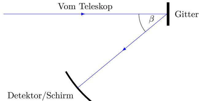
ii. (1.25 P.) Sous quel angle peut-on observer le premier maximum de la raie rouge H- $\alpha$  (656.281 nm) ? Pour simplifier, on admet que la lumière frappe le réseau perpendiculairement.
