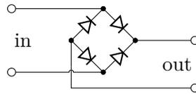
On admet que les diodes sont idéales et ont une tension de seuil nulle.
