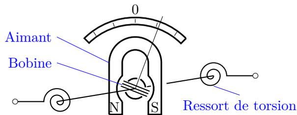
i. (0.5 P.) Que mesure un galvanomètre ?
