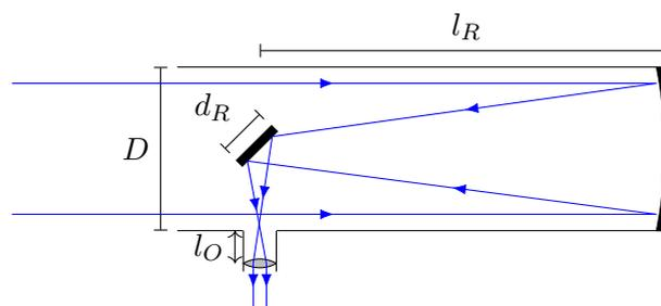
ii. (1.75 P.) A quelle distance  $l_O$  doit-on placer l'oculaire de façon à ce que les rayons provenant d'une étoile très lointaine soient parallèles après l'oculaire ?
