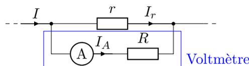
**i. (0.25 P.)** Calculez la tension aux bornes de l'élément en fonction de la résistance  $R$  et du courant  $I_A$  mesuré dans l'ampèremètre.
