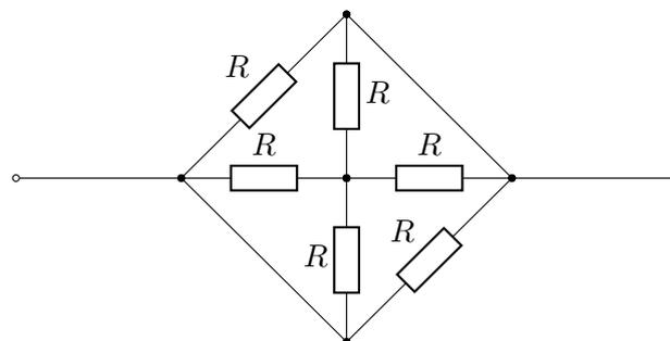
Quelle est la résistance équivalente du système ?
