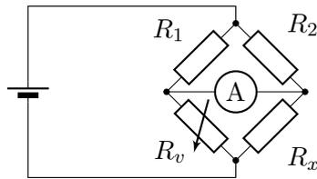
Pour calculer la résistance inconnue  $R_x$ , on fait varier  $R_v$  jusqu'à ce que l'ampèremètre indique zéro.
