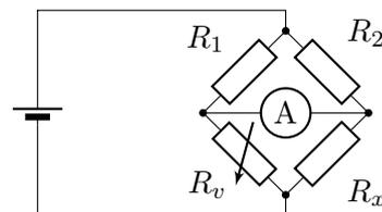
Pour calculer la résistance inconnue  $R_x$ , on fait varier  $R_v$  jusqu'à ce que l'ampèremètre indique zéro.
